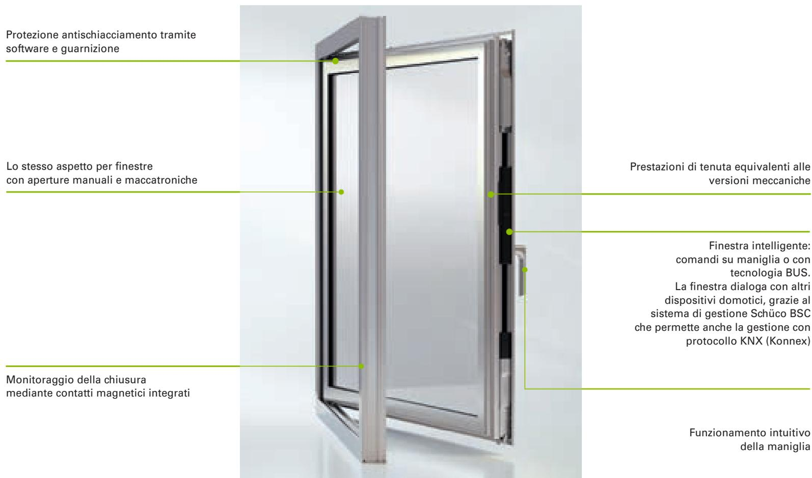
Grazie al sistema Schüco TipTronic è possibile aprire e chiudere le finestre, porte finestre e scorrevoli automaticamente con un semplice click su un pulsante del serramento oppure a distanza, anche con il proprio smartphone.
